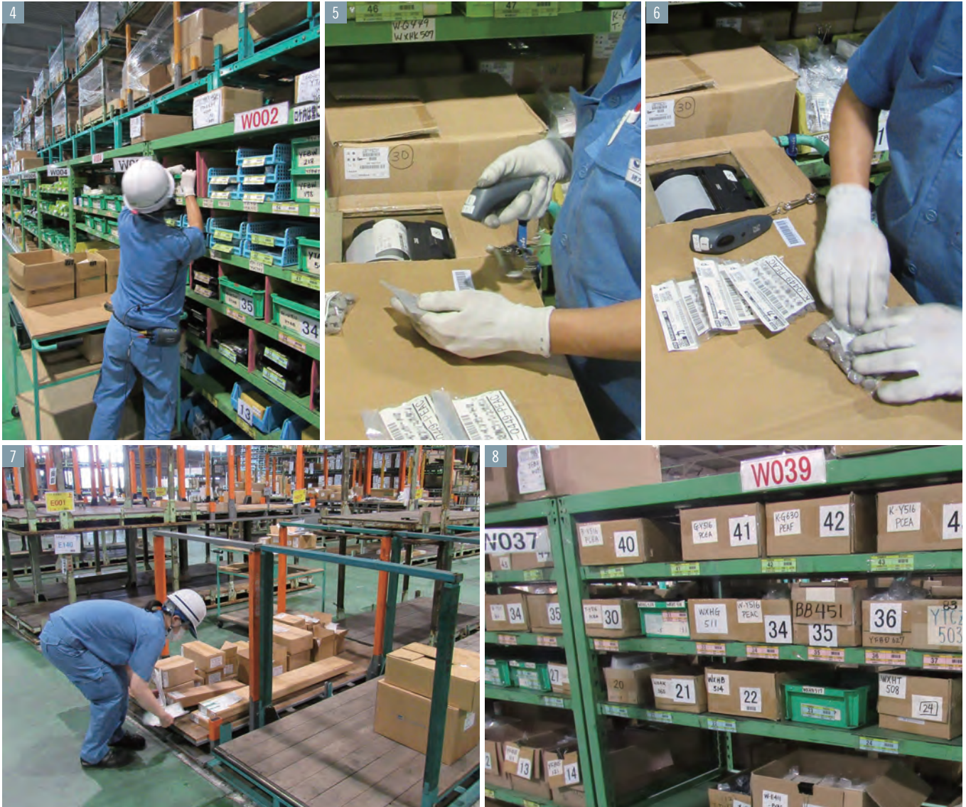
④両手が自由(ハンズ・フリー)なのでピッキングがしやすい ⑤ピッキングした部品のスキャン ⑥配送ラベルの貼付 ⑦出荷ピットの様子 ⑧棚番が付与されたロケーション
