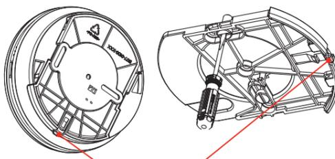
Pojistka s vylomitelným dílem
